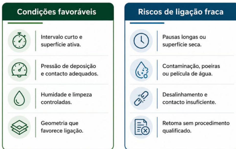
Figura 18 - Condições favoráveis e fatores de risco na ligação entre camadas.
