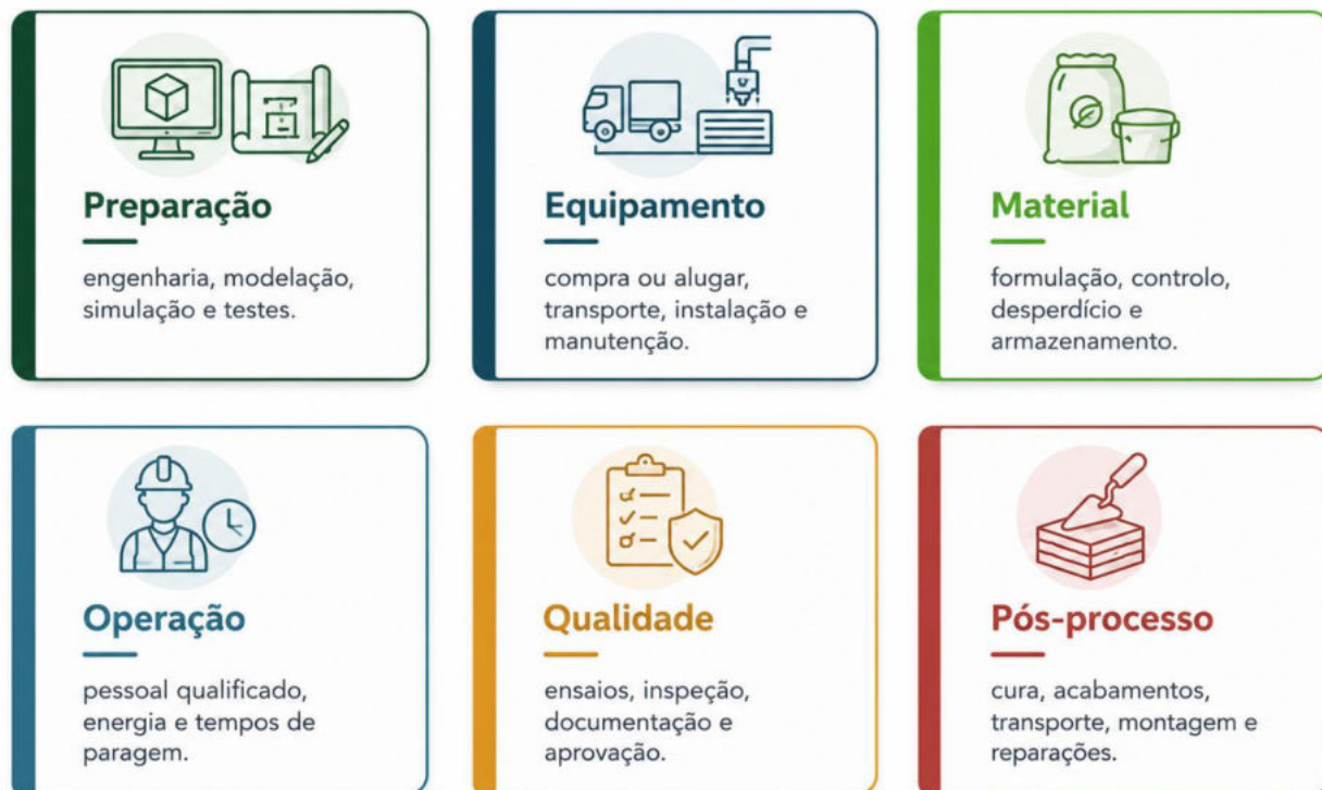
Figura 32 - Principais componentes a considerar na avaliação da adoção da impressão 3D na construção.
