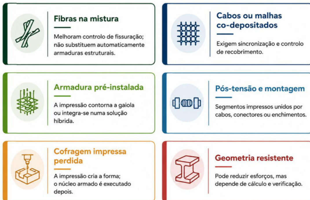
Figura 19 - Principais estratégias de reforço e integração híbrida na impressão 3D para a construção.
