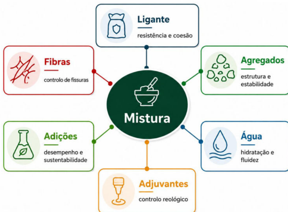
Figura 16 - Funções dos principais constituintes de uma mistura imprimível.
