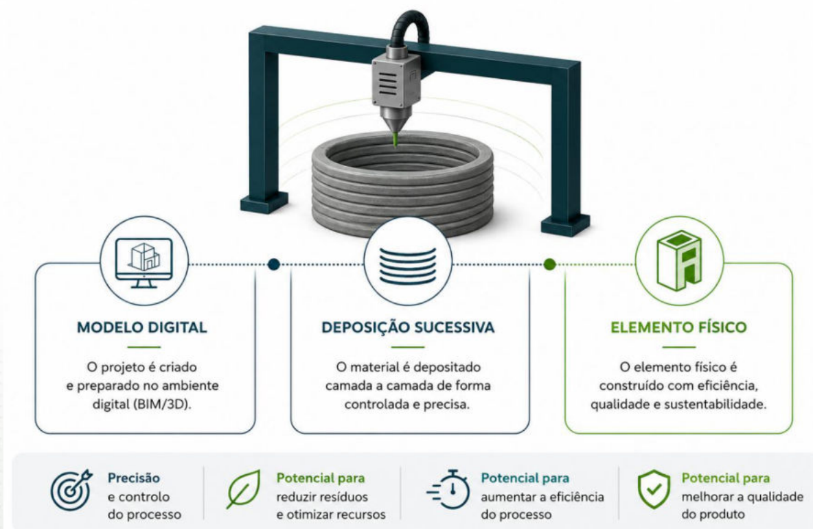
Figura 4 - Princípio de funcionamento da impressão 3D na construção: do modelo digital ao elemento físico.
