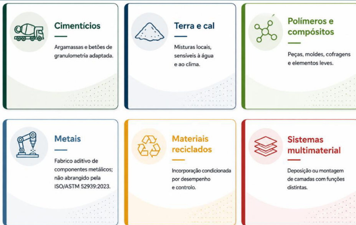
Figura 13 - Principais famílias e abordagens de materiais utilizadas na impressão 3D para a construção.
