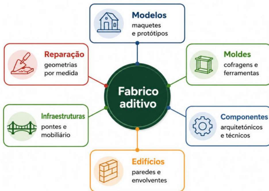
Figura 23 - Principais aplicações do fabrico aditivo (impressão 3D) na construção.
