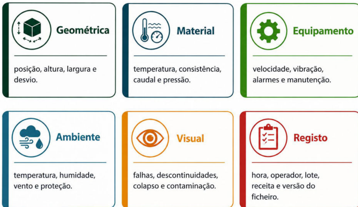
Figura 40 - Principais parâmetros de monitorização do processo de impressão 3D na construção.
