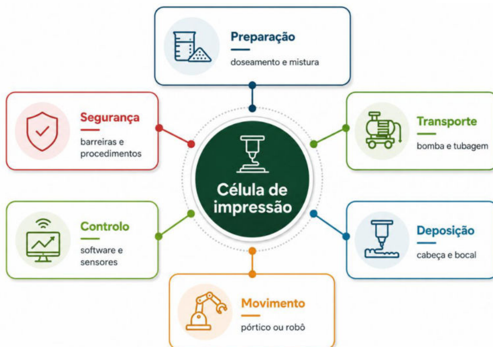
Figura 11 - Principais subsistemas de uma célula de impressão 3D.
