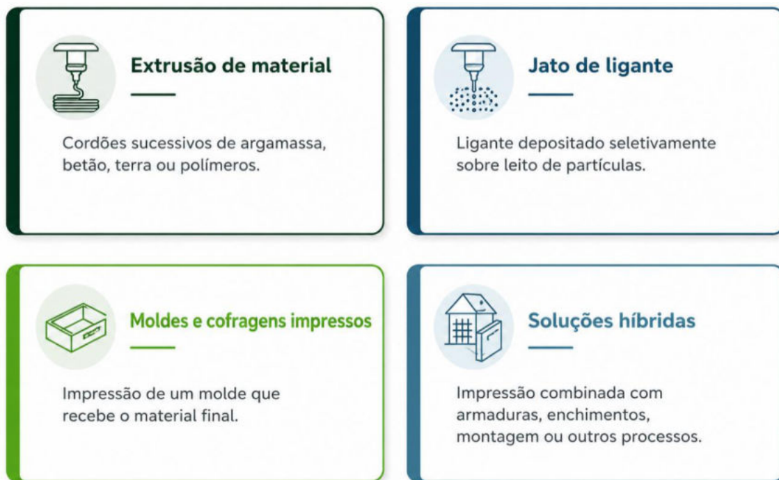
Figura 7 - Principais abordagens de impressão 3D aplicadas à construção.
