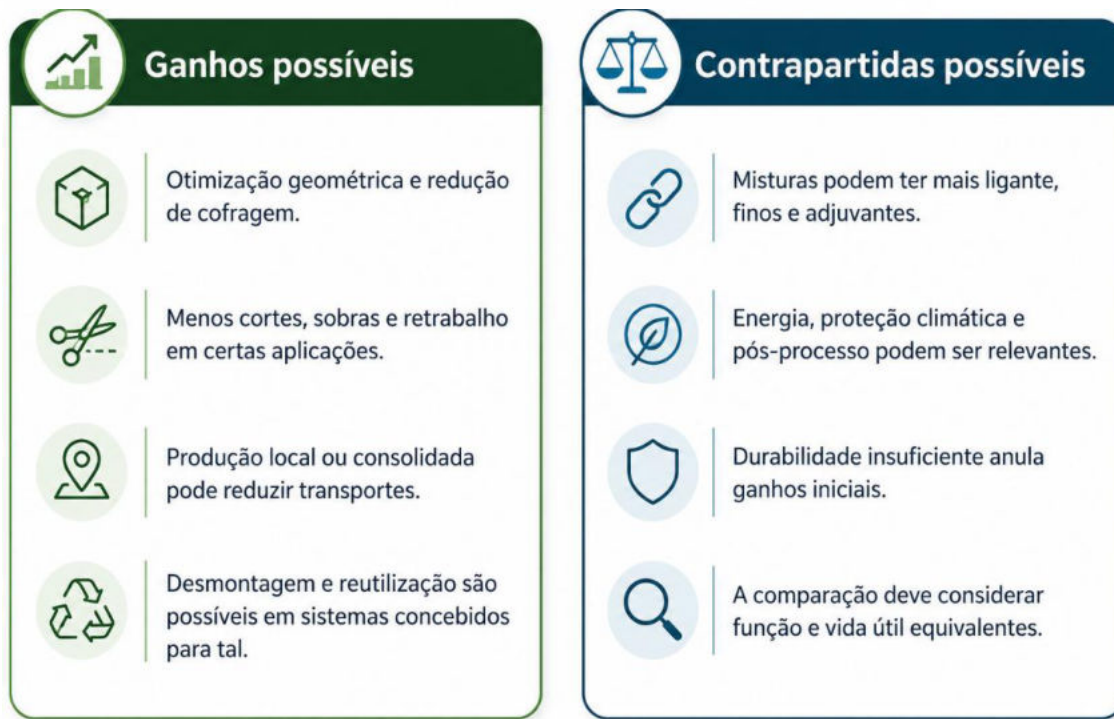
Figura 35 - Principais ganhos e contrapartidas ambientais associados à impressão 3D na construção.
